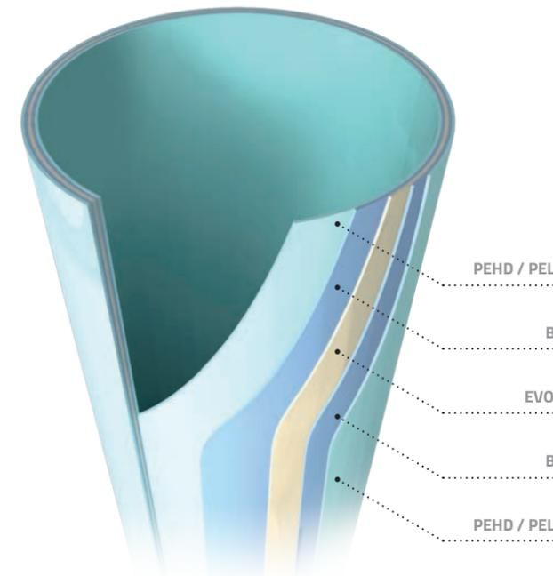
**STRUTTURA DEL TUBO COEX**
